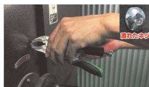
③ 夾緊手柄, 鉗口有特殊的直溝槽設計可緊咬螺絲並拔除
