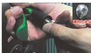
② 依順時針方向旋緊尾端的調節旋鈕約半圈
