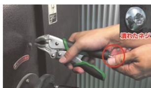
① 調整手柄尾端的旋鈕使開口寬度調至螺絲頭的直徑大小
